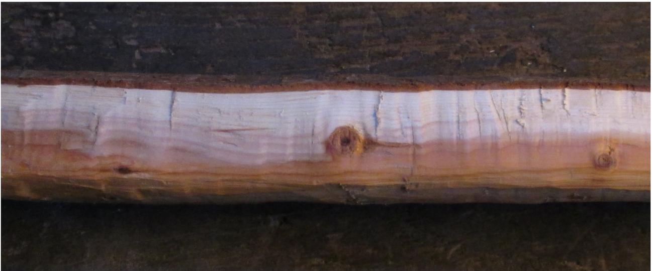
Fig 6 esempio di tronchetto di tasso sgrossato a sezione quadrangolare
